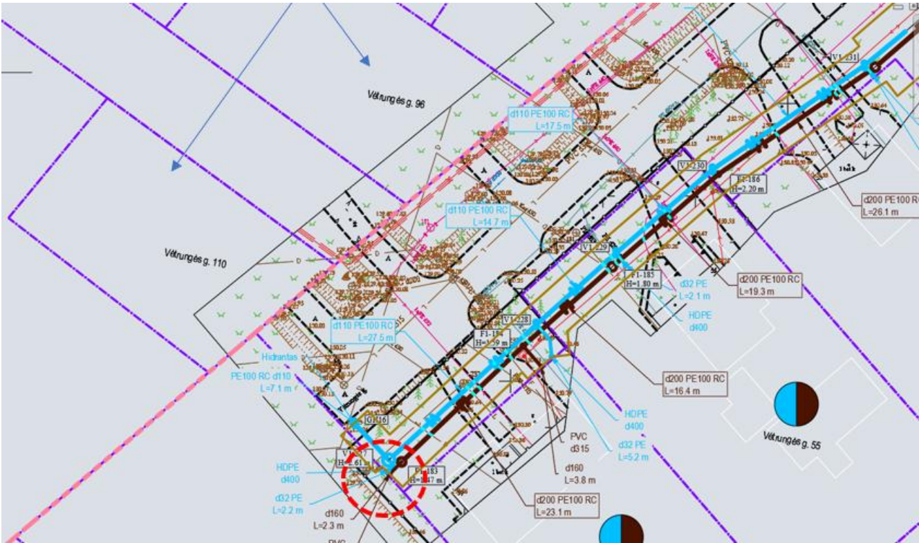
Suprojektuotas hidrantas Vėtrungės gatvėje.
