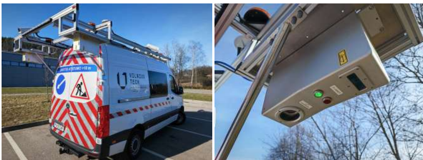
2.1 pav. Kelio dangos pažaidų lazerinė atpažinimo ir būklės vertinimo sistema IRIS
